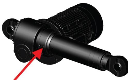
Lubrique el cilindro electromecánico a través de la boquilla con aproximadamente 100 g/1000 mm de carrera. No utilice más grasa de la recomendada.
